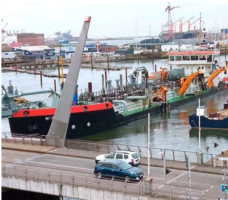
La drague aspiratrice en marche dans le chenal avec le plan d'eau du YCMN au fond (Photo Hubert)
